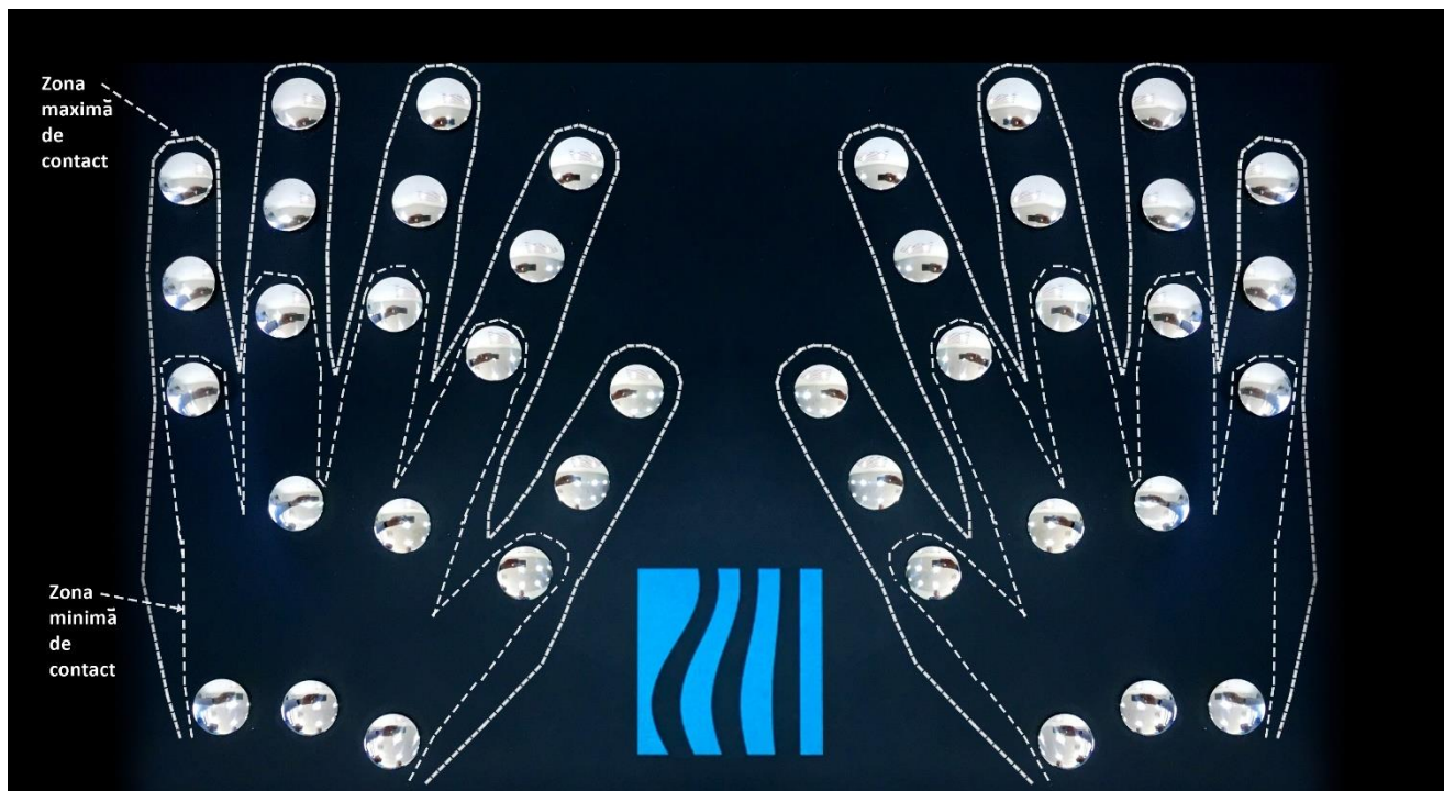
Fig. 7 – Senzori MindSpring™ – zona de contact a pielii cu senzorii
